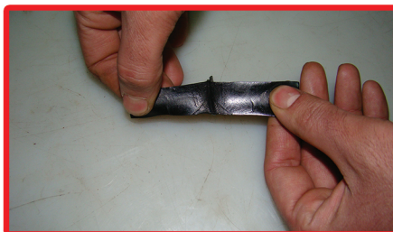
۲- کنترل کیفیت از نظر چسبندگی (کیفیت خوب یعنی در اثر فشار یکپارچه شود)
