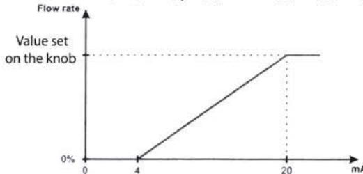
در حالت جریان متغیر همانند حالت ثابت میتوان از بکی از دو پمپی که بر اساس درجه های تنظیم شده عمل می کنند استفاده نمود . پمپ های مدل HC 150 mA را میتوان جهت تنظیم در حالت کارکرد نسبی به هفراه هر وسیله تنظیم کننده ای که قابلیت تامین سیگنال جریان بین 4 تا 20 میلی آمپر اداشته باشند (همانند سنسورهای اندازه کیری redox ، PH ، کلر و دستگاه های اندازه کیری هدایت الکتریکی Conductivity) استفاده نمود . سنسور را باید با استفاده از کابل و با رعایت قطیعت سیم ها به اتصالگر قرمز رنگ BNC پمپ متصل نمود .
