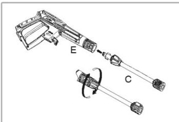
نازل قابل تنظیم را به کانکتور رابط متصل کنید. برای این کار فقط کافیست نازل را داخل کانکتور وارد کرده و کمی فشار داده تا محکم شود. در صورت اتصال صحیح، با کشیدن نازل نمیتوان آن را از کانکتور جدا نمود. بسته به نوع سطح قابل شستشو میتوانید نازل توربو رانیز طبق روش فوق به لانس متصل کنید. تنها یکی از نازل ها را میتوانید به کانکتور متصل کنید. جهت استفاده صحیح از قطعات بایستی تمامی آنها به کانکتور متصل شوند.
