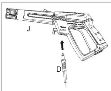
شیلنگ فشار قوی را با استفاده از کانکتور اتصال سریع به لنس متصل کرده و کاملاً محکم کنید تااز نشتنی آب جلوگیری شود. در صورت اتصال صحیح، باکشیدن شیلنگ نمیتوان آن را از لنس جدا نمود.
