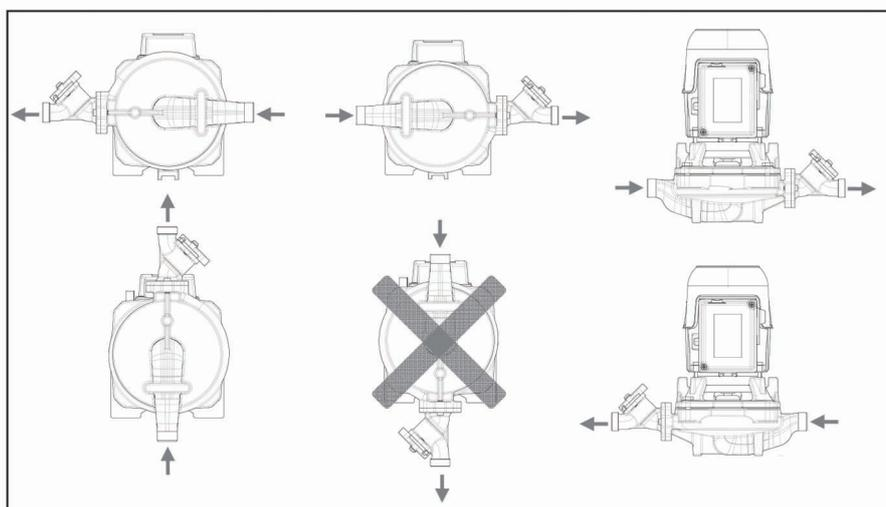
در خروجی محل تخلیه آب در پمپ سری K-HA سوچ کنترل جریان آب در نظر گرفته شده است که عملکرد موتور را کنترل کرده و در محل خروجی آب روی پایه نصب شده است. با رعایت دستورالعملهای اعلام شده، سوچ کنترل جریان آب را به درستی نصب کرده و از عملکرد صحیح آن اطمینان حاصل کنید. (بایستی سوچ کنترل جریان آب بصورتی نصب شود که در پوش مشکی رنگ آن بطرف بالا قرار گیرد)
