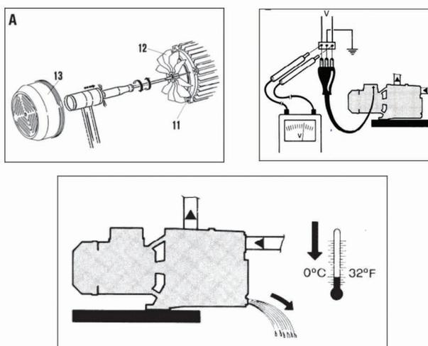
زمانی که فن خنک کننده نمی چرخد، پیچ گوشتی را نزدیک به شفت موتور فن قرار دهید و با چکش آرام بر روی پیچ گوشتی ضربه بزنید و شفت را بچرخانید و از گردش آن مطمئن شوید . سپس جریان برق را با ولت متر چک کنید . فشار آب مورد نیاز باید مطابق با مقدار مندرج در برچسب اطلاعات باشد . از اتصال دوشاخه به پریز برق و همچنین اتصال زمین اطمینان حاصل کنید .
