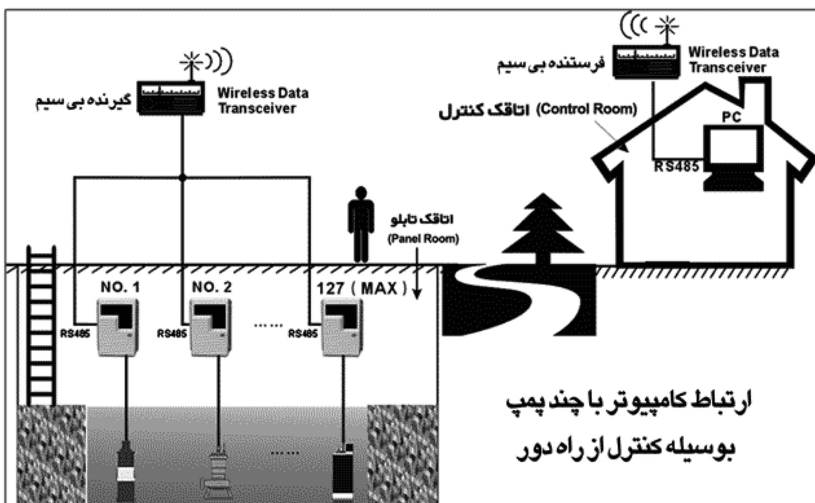
5- پروتکل RS485 یک وسیله تکرار کننده و تقویت کننده از مدل ModBus است که بین کامپیوتر و دستگاه اصلی و یا کامپیوتر و ریموت کنترل از راه دور متصل می گردد.
